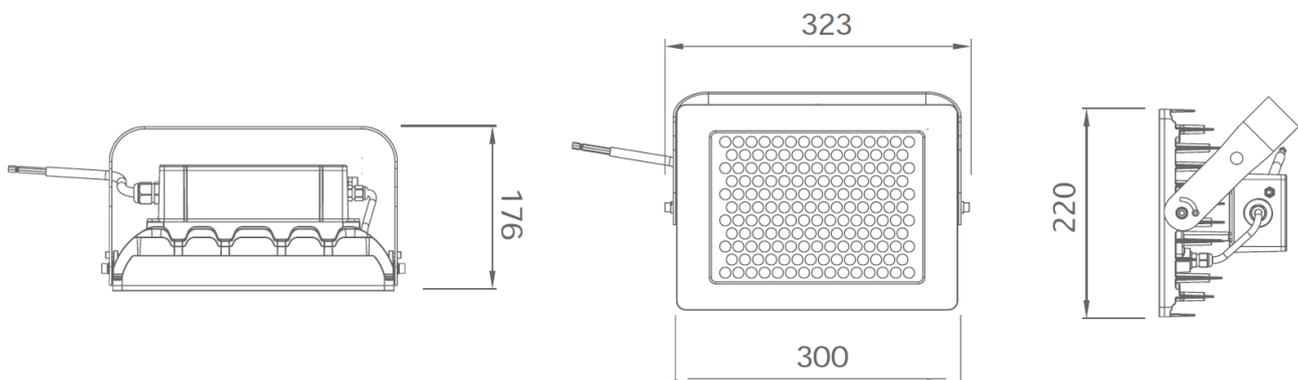
Das massive Aluminium-Druckgussgehäuse ist mit einer drehbaren Halterung aus Edelstahl ausgestattet.
