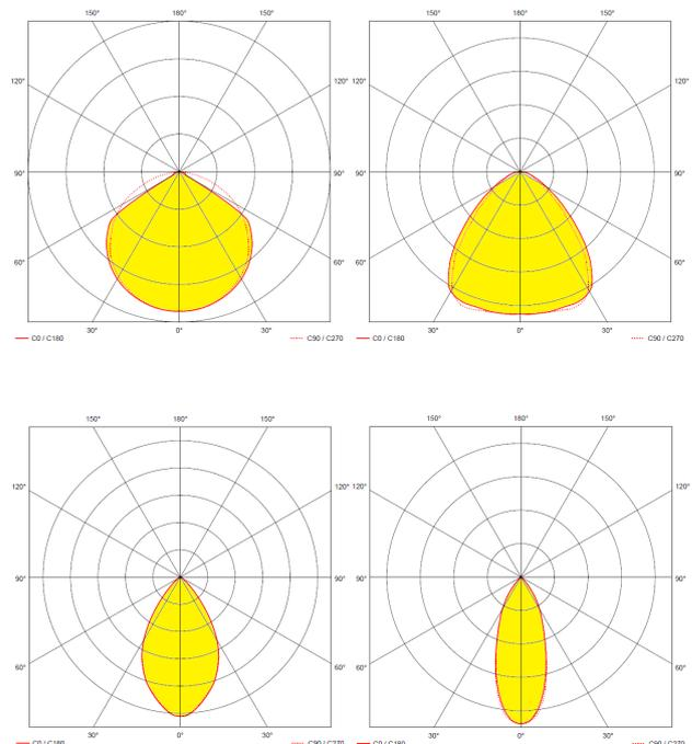
Durch unterschiedliche Reflektoren kann die Leuchte an verschiedene Montagehöhen ideal angepasst werden.
